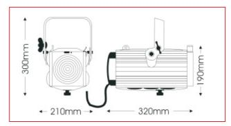
Versione 70W del popolare illuminatore fresnel, Soffio f70 si distingue per la gradevole linea, il ballast incorporato e le ridotte dimensioni d'ingombro. Produce un fascio di luce omogeneo e diffuso, sagomabile con il paraluce 4 alette accessorio.
