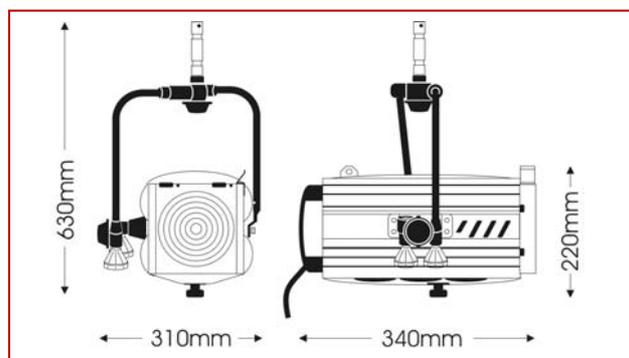
Illuminatore fresnel per lampade a scarica 250MSD, ideale per utilizzi architetture su aree espositive, in show room, vetrine, musei o centri commerciali. In questa versione è dotato di forcilla con comando a palo per il controllo della posizione orizzontale e verticale.
