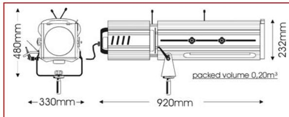
Canto® 250HR è un seguipersona a scarica unico nel suo genere. La lampada Philips ST250HR offre tutti i vantaggi della tecnologia della ceramica applicata ad utilizzi che erano stati fino ad oggi riservati solamente alle alogene.
